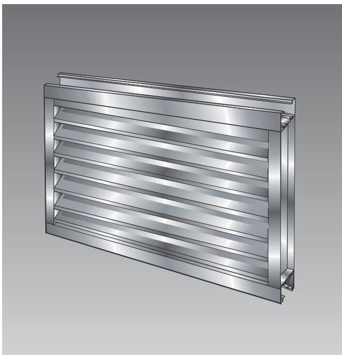
Sus aletas tipo "J", no drenables, colocadas en un ángulo de 30° reducen la penetración de agua de lluvia y proporcionan como mínimo un 50.1% de área libre efectiva.
