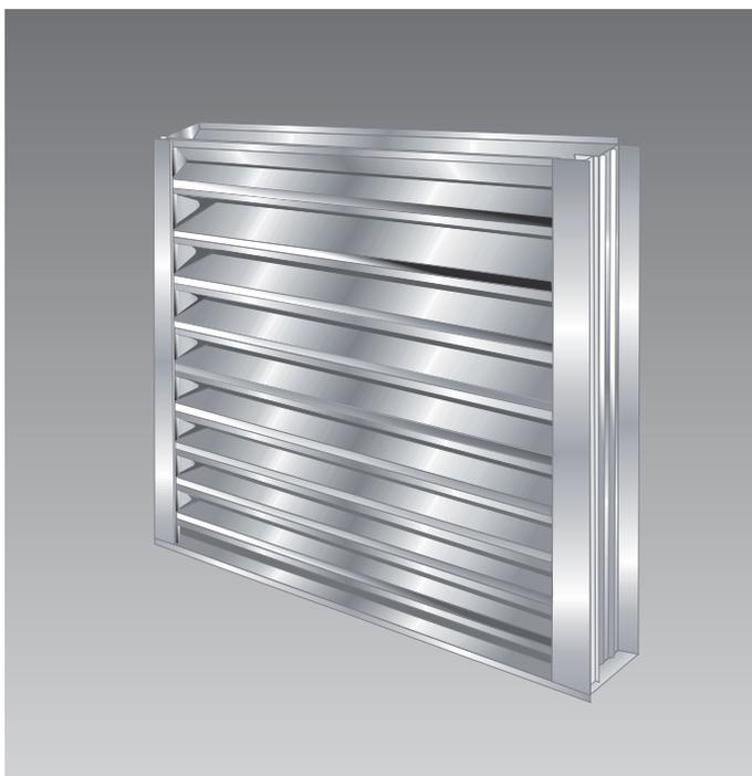
Sus aletas drenables colocadas en un ángulo de 45° reducen la penetración de agua de lluvia y proporcionan como mínimo un 46.6% de área libre.
